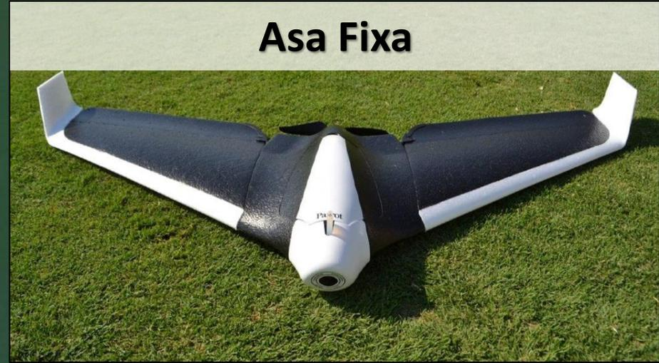
Apresenta em sua estrutura um corpo sustentado por asas fixas (não rotativas), essa sustentação ocorre através do fluxo de ar. Os VANTs de asa fixa se assemelham bastante a aviões.
